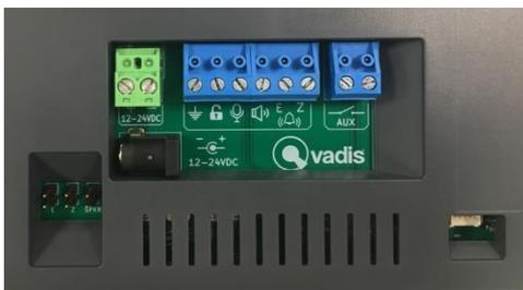
Conectar la Clema 6p a la parte trasera del Qvadis®, y conectar la toma (o jack) del alimentador al dispositivo.
