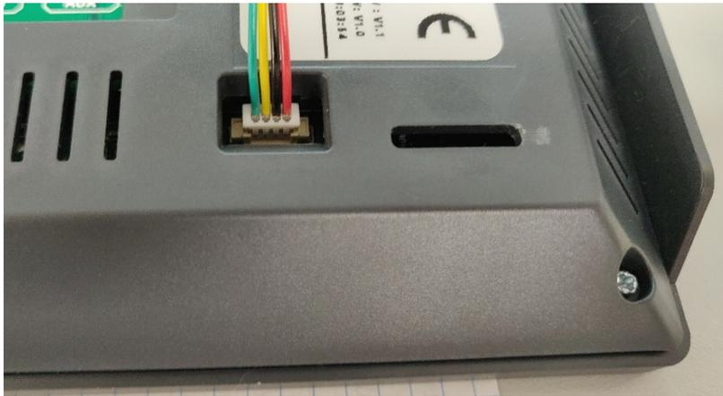
A continuación, inserta la placa QDS en los pines de la parte trasera de tu Qvadis® One, y conecta el extremo libre del cable de comunicación a la placa DS Adapter.
