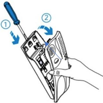
Otros tienen una pestaña de plástico que sujeta las dos mitades de la carcasa. Suele estar situada en la parte superior o inferior. En este caso, puedes utilizar un destornillador para presionar con cuidado esta pestaña y separar fácilmente las dos piezas de plástico que componen el terminal.
