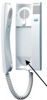
Algunos modelos tienen un tornillo visible bajo el auricular. Basta con desatornillarlo para poder abrir la carcasa y acceder a las conexiones internas.
