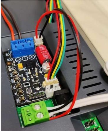
Afloje los tornillos de la clema verde en el extremo de la fuente de alimentación, conecte el latiguillo L1, con cuidado de mantener la polaridad correcta como se muestra en la imagen.
